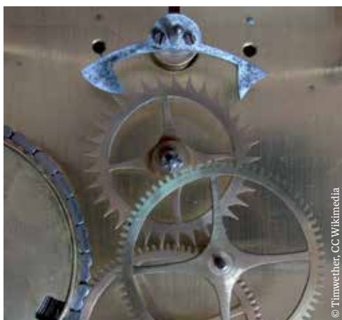
Der Uhrmacher John Harrison half im 18. Jahrhundert mit, die Längengrade auf See exakter zu bestimmen. Dazu erfand er die unter anderem die Grasshopper-Hemmung.
